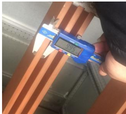
主开关出线与主母线间的连接排厚度
