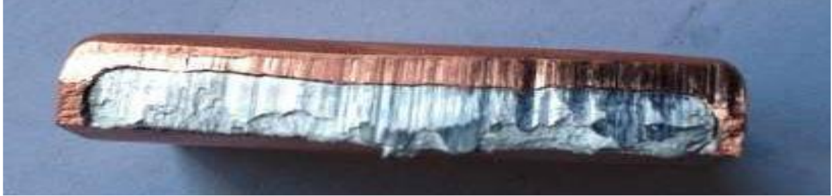
사진 6. 펀칭 금형 사용 불량으로 발생한 불량 가공품 사진
